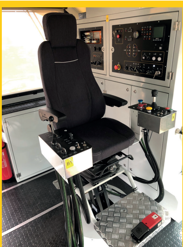
Siège du conducteur pivotant en fonction du sens de marche
